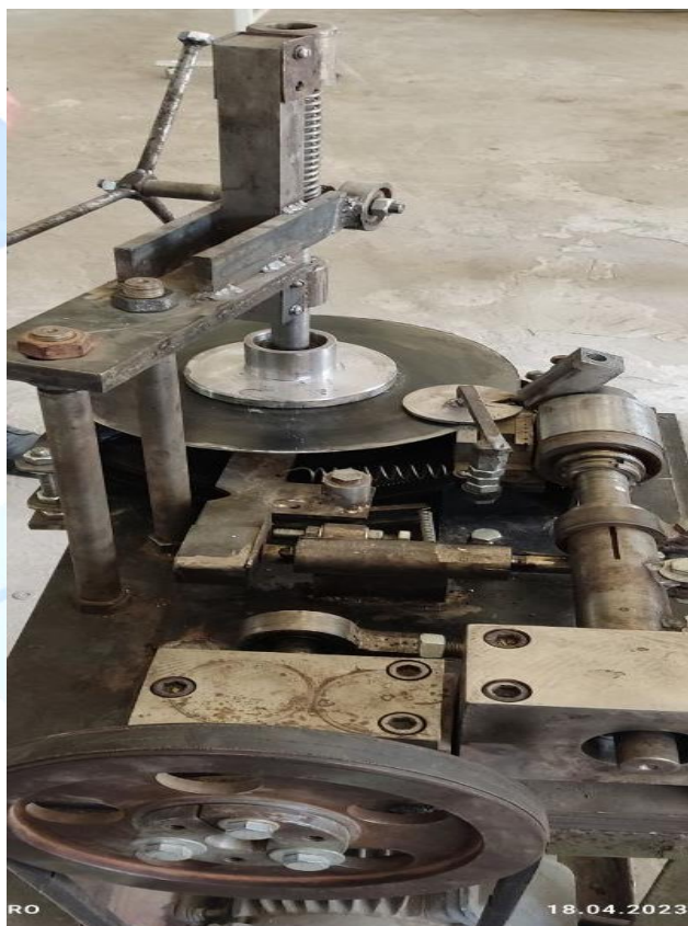
Рисунок 6. Общий вид изготовленного нового пилонасекательного станка в АО «РИМ Устахонаси»
